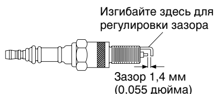
Рис. 12. Регулировка зазора свечи зажигания, нагреватель мощностью 10 кВт
